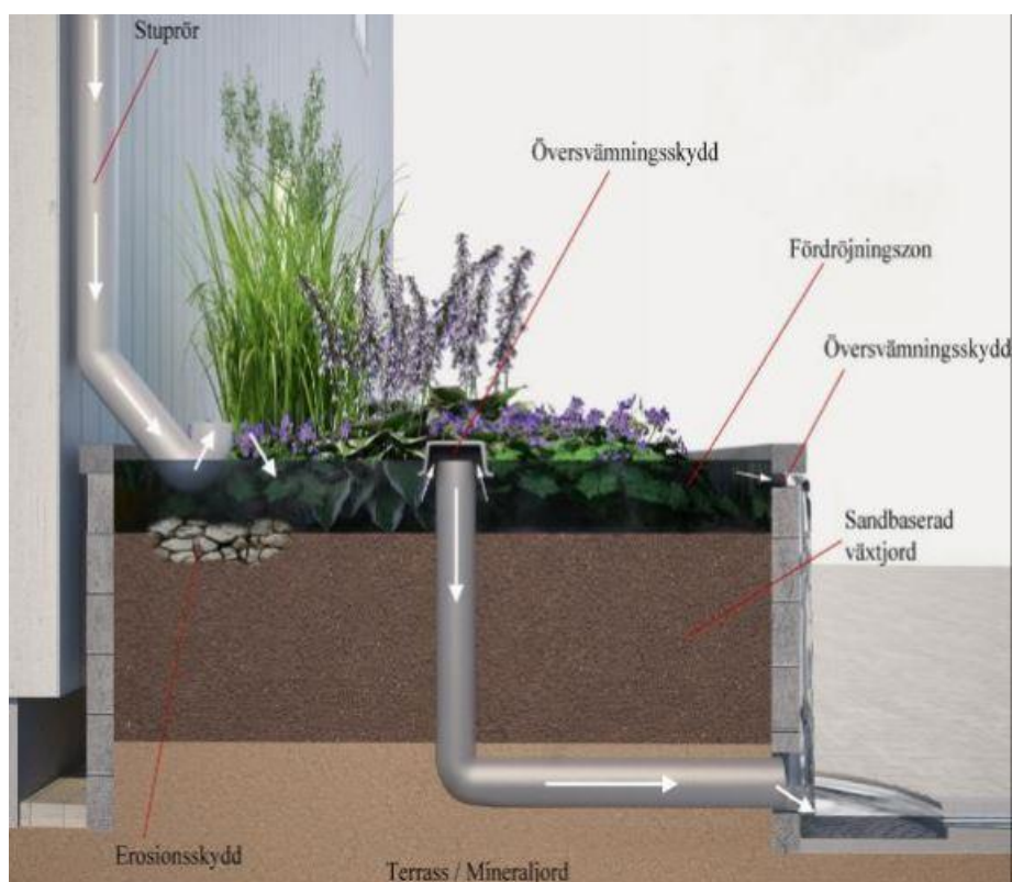
Figur 11. Principskiss över regnträdgård/växtbädd anslutning med stuprör.
