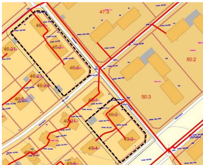
Kartbild över de befintliga fjärrvärmeledningarna inom planområdet. Planområdet är markerat med svart streckad linje.
