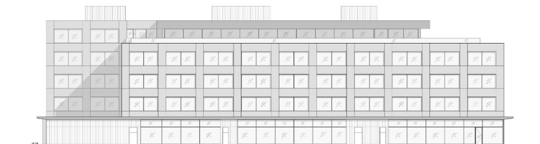
Exempel på fasadritning mot nordväst. Det indragna hörnet mot Björkgatan syns till vänster i bild.
