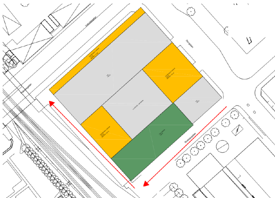
Förslag på ny sekundär avrinningsväg visas med röda pilar. Bjerking.
