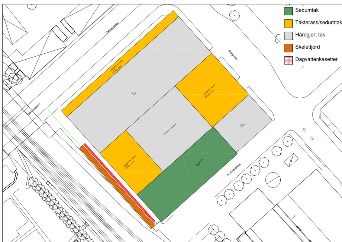
Figur 10. Alternativ 1 för fördröjning och rening av de första 20 mm. Gula ytor kan både anläggas som hårdgjorda samt som sedumtak. Minsta sedumtaketyta måste vara 2 540 kvadratmeter. Övriga ytor leds till dagvattenkassetter och sedan vidare till skelettjord.
