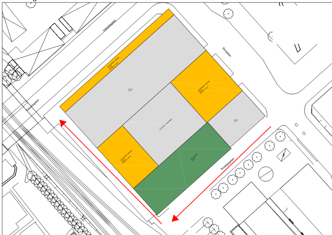
Figur 12. Ny föreslagen sekundär avrinningsväg efter exploatering.
