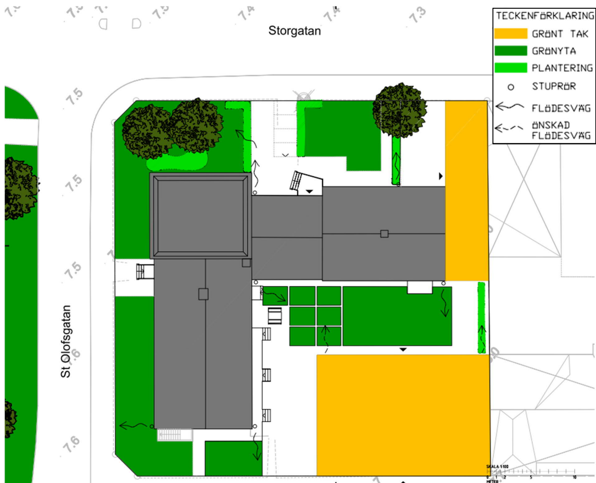
Figur 12. Illustration över dagvattenhantering för fastigheten. Stuprörsplacering för de nya byggnaderna är inte kända men de placeras med fördel så att överskottsvatten leds till grönytor. Önskad flödesväg är illustrerad med streckade pilar.
