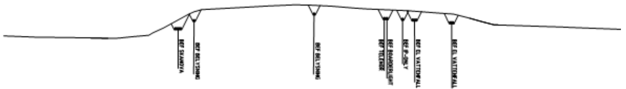
Bild 6. Sektion C-C, sektion D-D. Sektionerna visar befintliga ledningar som ligger i befintlig väg (belysning) och vid sidan av vägen.
