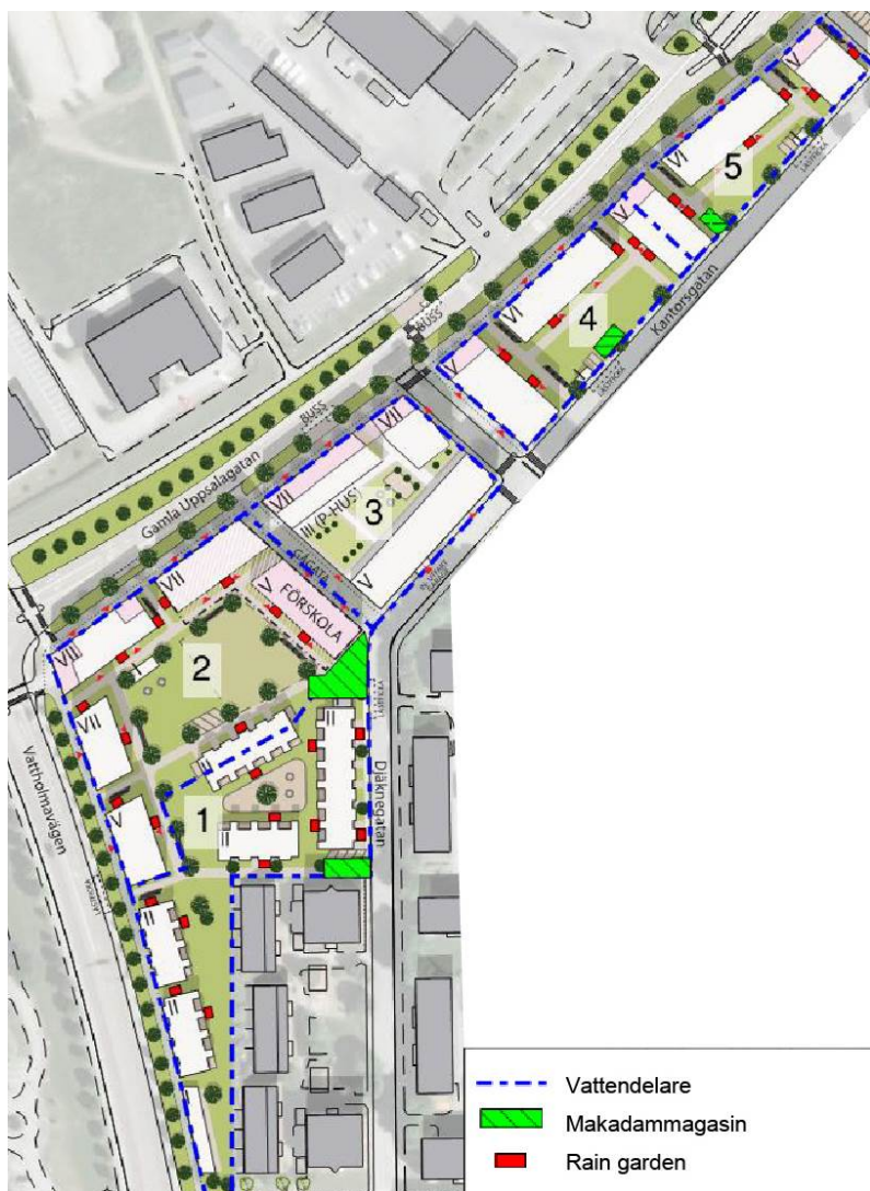
Förslag till placering av fördröjningsmagasin och raingardens (Dagvattenutredning, Bjerking 2016-05-05). Utsatta raingardens är inte skalenliga.
