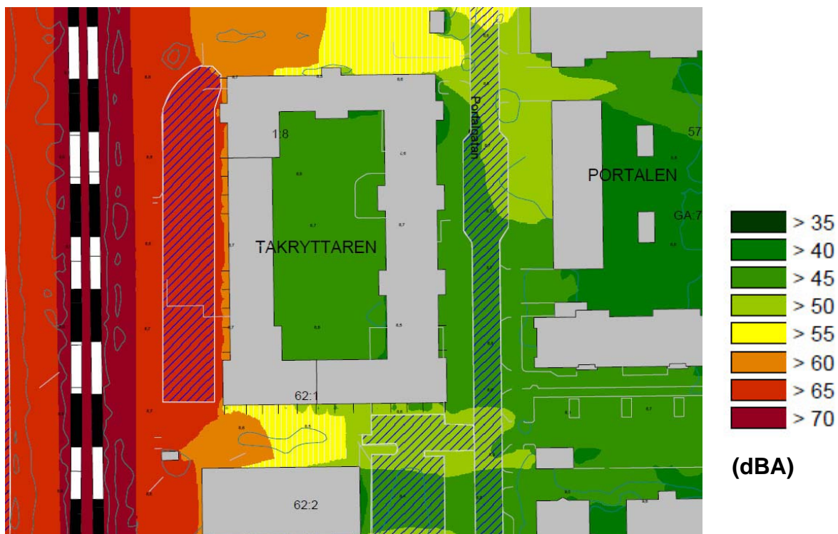
Ljudnivåerna blir högst vid fasaden mot järnvägen med ekvivalenta ljudnivåer på 63–65 dBA. Kartan visar bullernivåer från spårtrafik beräknat 2 meter över mark. (Illustration av Akustikbyrån)
