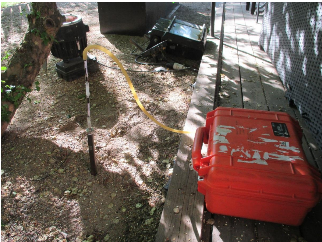
Bild 3: Provtagningspunkt 1, provtagningssond med monterad pump och adsorbentrör 2016-06-01.
