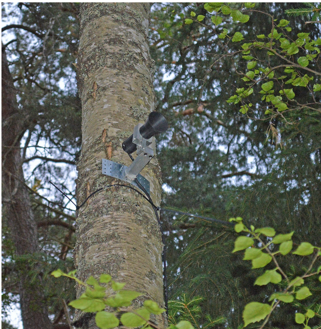
Figur 4. Mikrofoner placerades på ca 5 meters höjd på två platser ute i skogen. Kablarna drogs upp i trädkronorna till Silikatets förskola där två Avisofthenheter kopplades ihop med en dator och en extern hårddisk.
