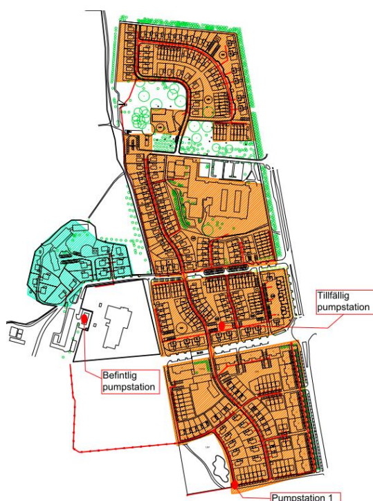
Figur 5 Orangefärgat område leds med självfall till pumpstation 1, där vattnet pumpas till befintlig pumpstation. Turkost område leds med självfall till befintlig pumpstation.
