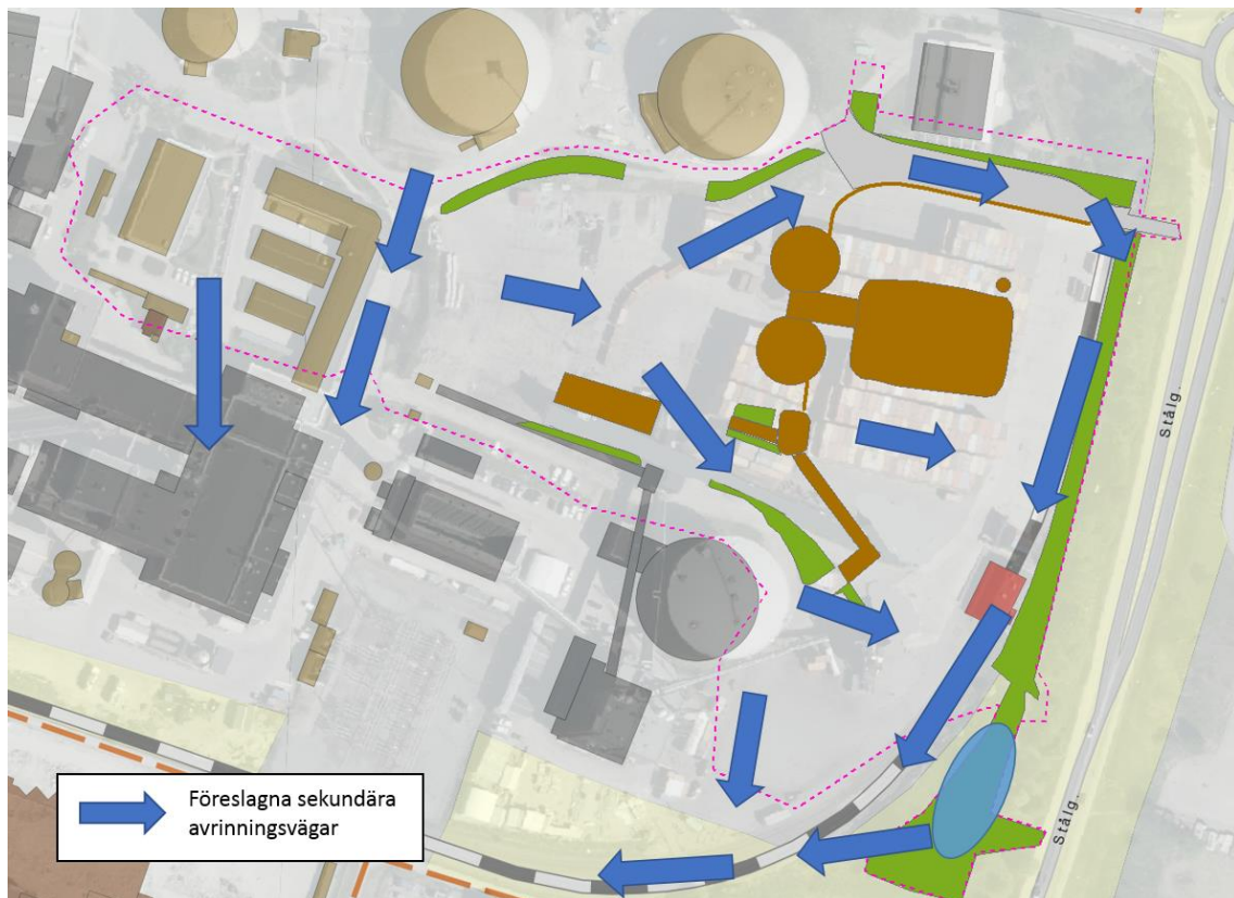
Figur 12. Figuren visar föreslagna sekundära avrinningsvägar för avrinnande vatten vid höga flöden.
