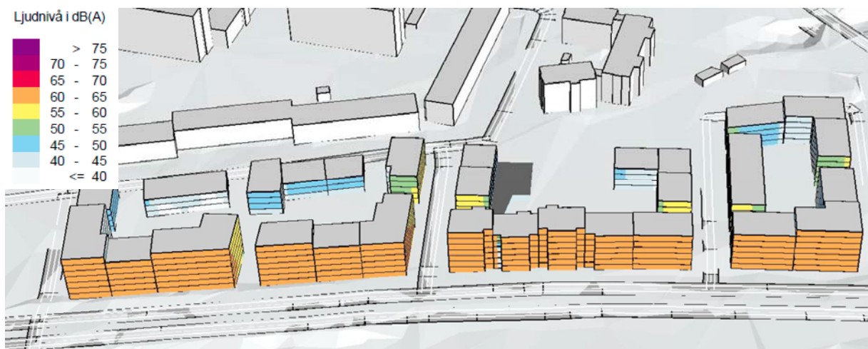
Bilden visar ekvivalenta ljudnivåer vid fasader mot Fyrislundsgatan. Sweco
