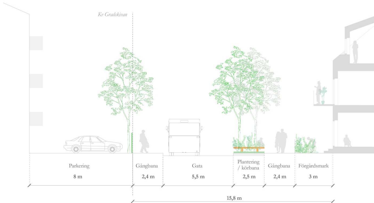
Bilden visar en principsektion för Johannesbäcksgatan.
