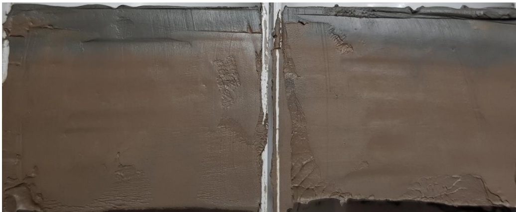
Figur 2 Borrpunkten, BG19001, 3,5 m, Jordprovet i övre delen av mellanhylsan delad longitudinellt provhylsan med id Bjerking 963.
