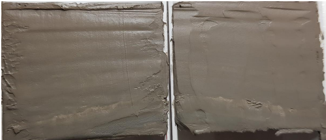
Figur 5 Borrpunkten, BG19003, 5,0 m, Jordprovet i övre delen av mellanhylsan delad longitudinellt provhylsan med id Bjerking 957.
