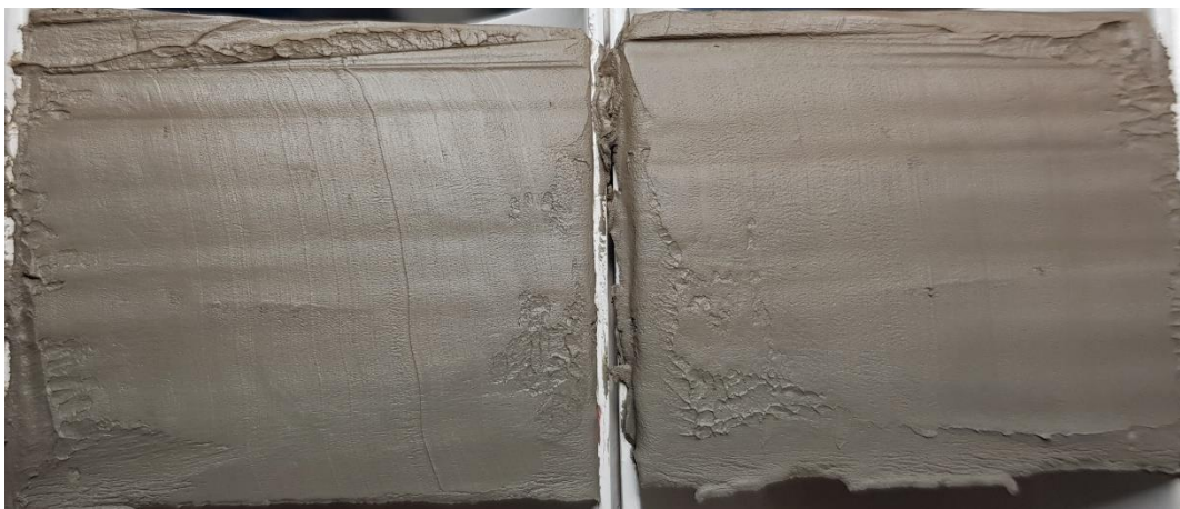
Figur 6 Borrpunkten, BG19001, 7,0 m, Jordprovet i övre delen av mellanhylsan delad longitudinellt provhylsan med id Bjerking 373.
