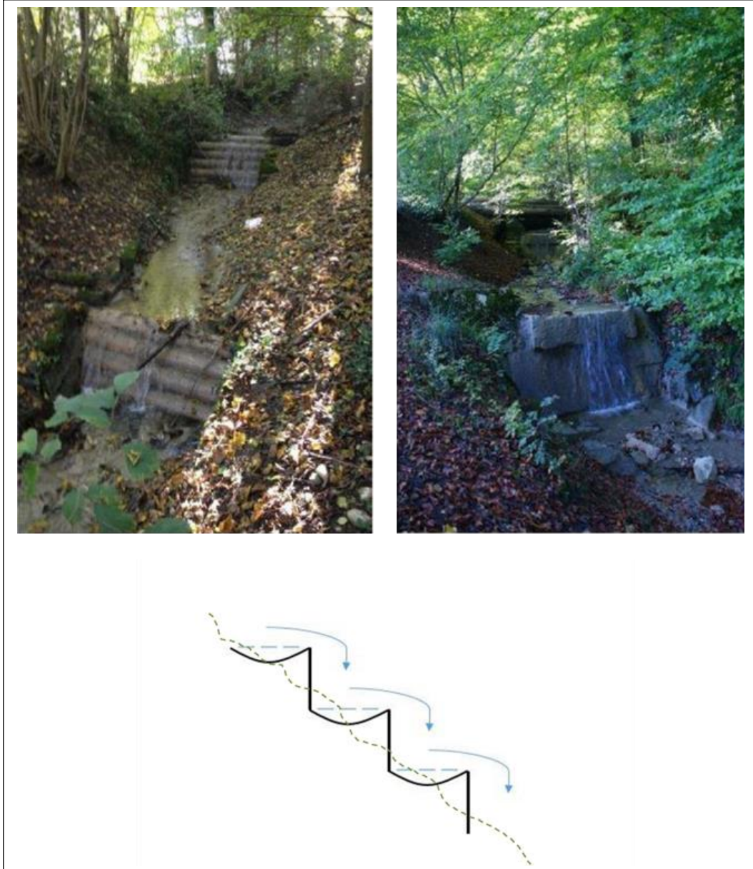
Bild 14. Principskiss över terrassering i naturmark där dagvatten kan renas och fördröjas
