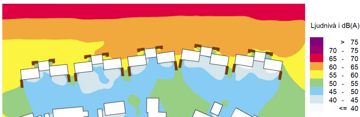
Figur 2. Ekvivalenta ljudnivåer för uteplats. Observera att figuren är roterad. Bullerskyddsskärmar är markerade i brunt.
