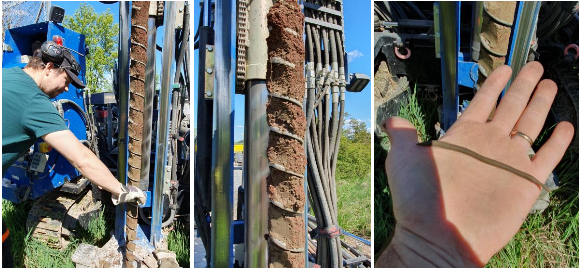
Bild 4.2.1 - 4.2.3: Bilderna visar provtagning med skruvprovtagare från punkt i punkt 6. Höger bild visar att materialet är rullbart vilket är en fältindikation på att materialet i huvudsak utgörs av lera.
