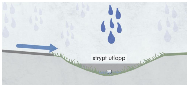
Figur 15. Principskiss för ett svackdike med ett överfall. Större flöden kan passera över överfallet, medan mindre flöden stryps till önskat flöde genom konstruktionen (Illustration: Sweco).
