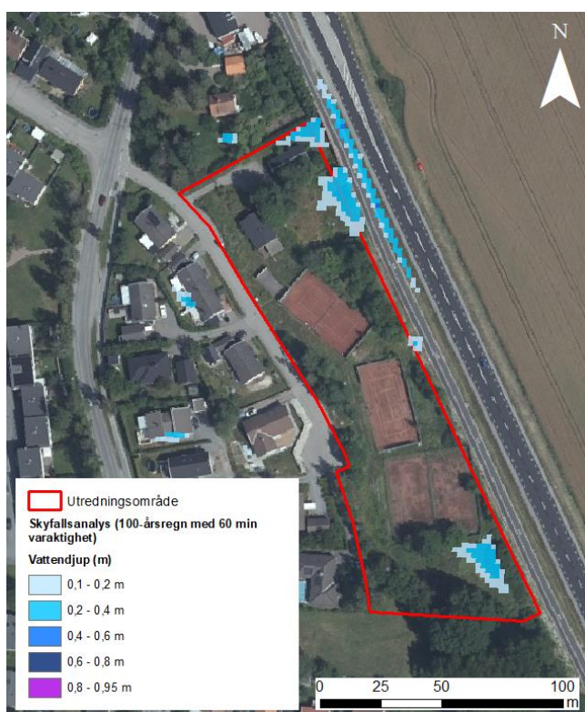
Figur 7. Vattendjup i lokala lågpunkter vid kraftiga regn (67,5 mm, motsvarande ett 100-års regn med 60 minuters varaktighet och klimatfaktor 25%). Bakgrund: Ortofoto från Lantmäteriets visningstjänst.
