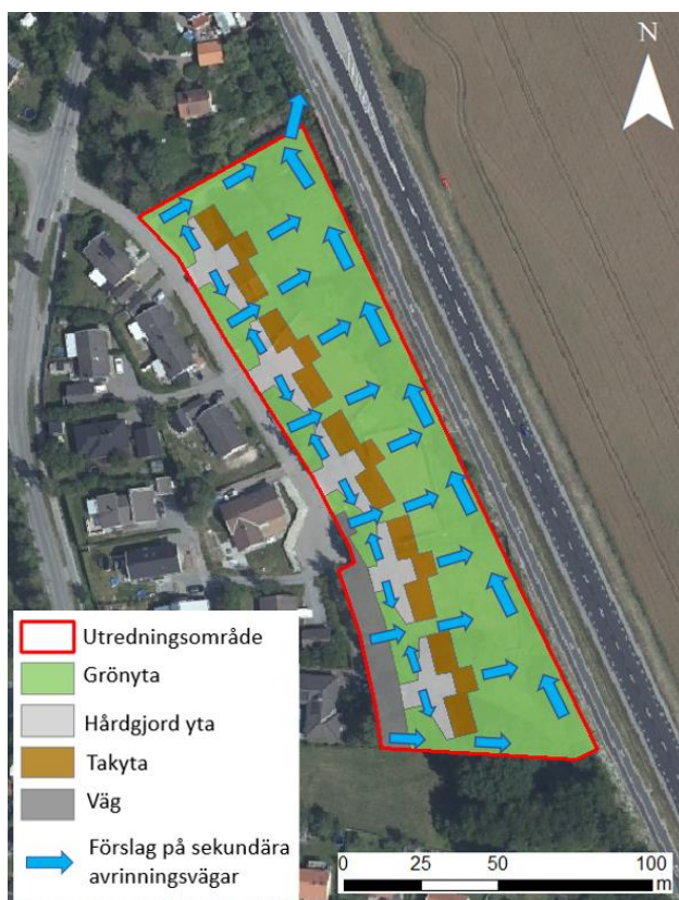
Figur 13. Figuren visar rekommenderade sekundära avrinningsvägar vid skyfall, dvs. lågstråk och lutningar i terrängen där stora volymer vatten kan avrinna.
