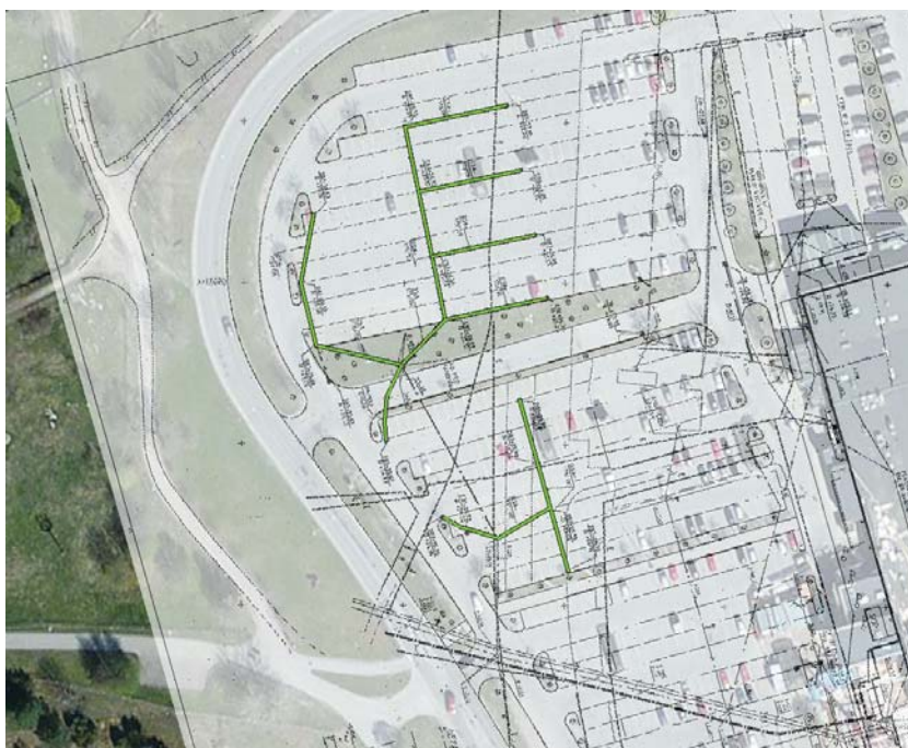
Figur 5. Befintligt fördröjningsmagasin som är beläget i planområdets nordvästra del
