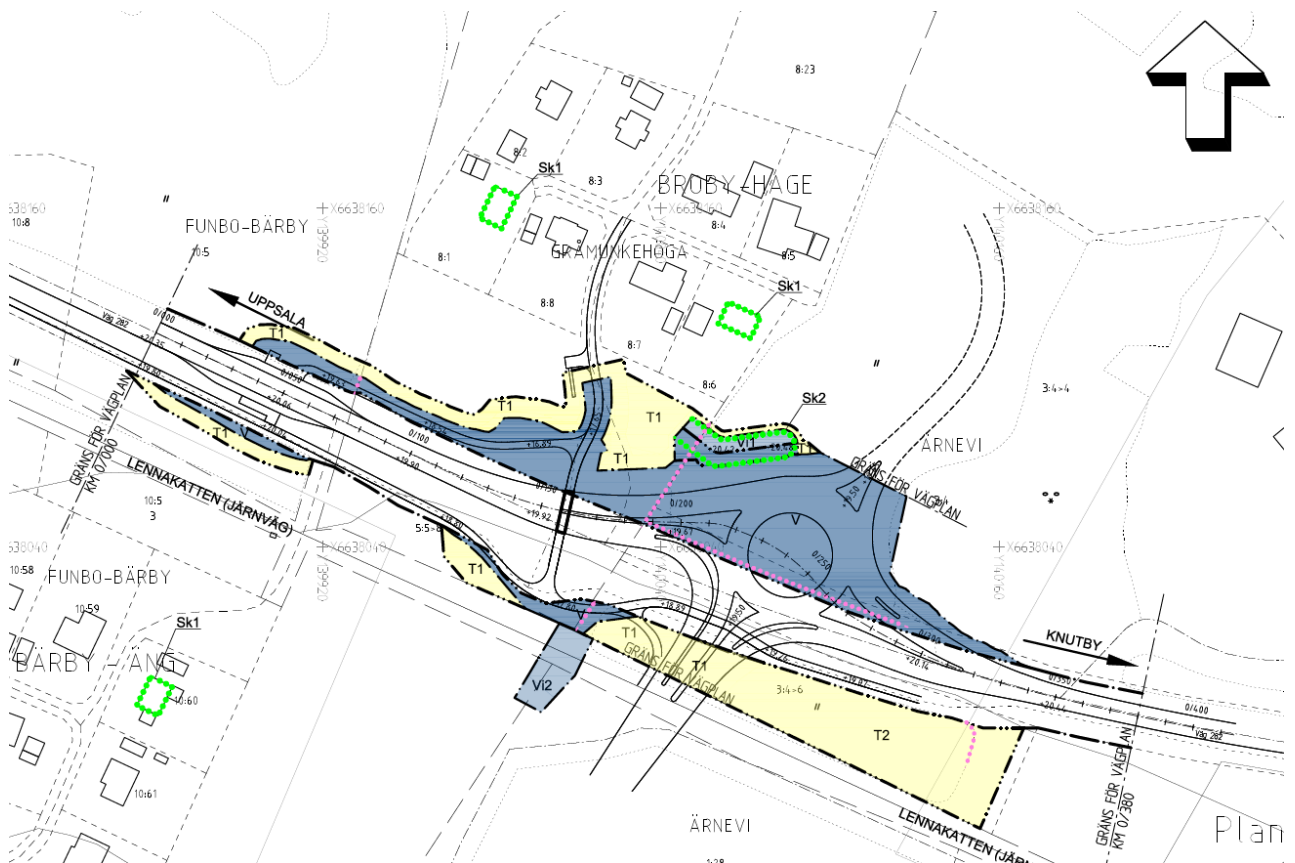
Vägplanen enligt Trafikverkets granskningshandling. Permanent markanspråk (vägplan) är markerat med blå och tillfälligt markanspråk under byggnationstid är markerat med gul.
