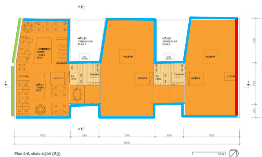
Bild 4 Fönsterdimensionering, isolering i fasad av cellplast. R_w + C = 41 dB mot Vimpelgatan, R_w + C = 38 dB för långsidor och R_w + C_{tr} = 34 dB för fasad mot Kungsgatan.
