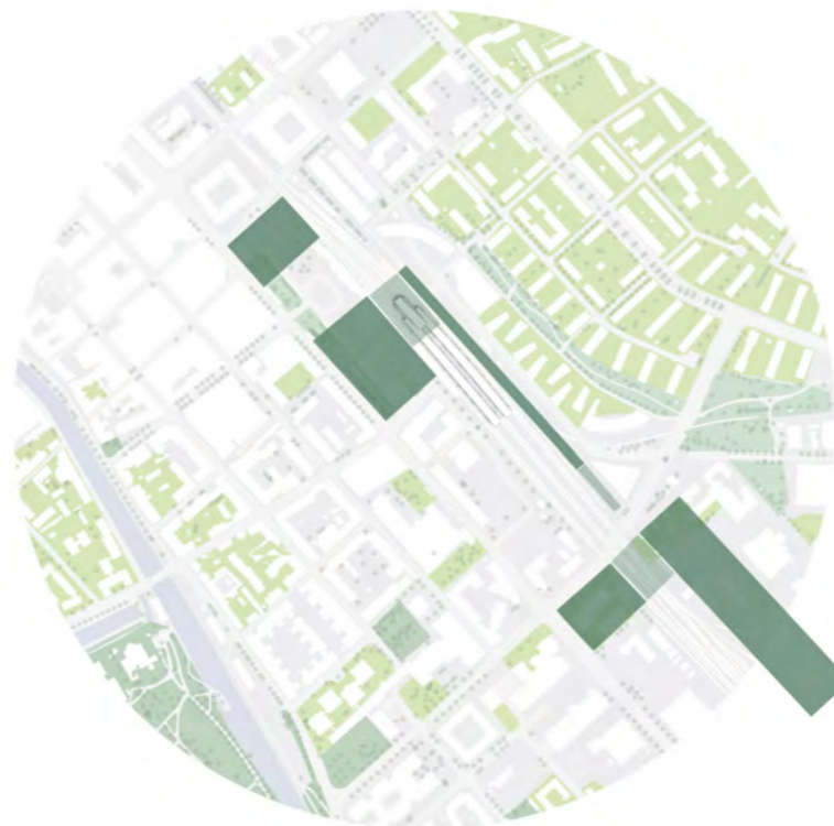
Plandiagram som visar tillgängliga ytor för exploatering i grönt. Ytan i främre boländerna är begränsad på grund av säkerhetsavstånd till farlig verksamhet i området
